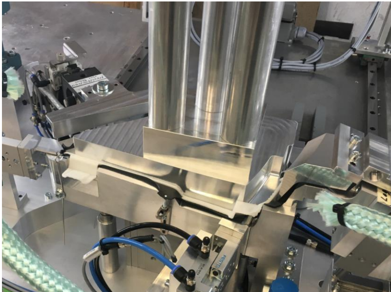
Druckteil mit Folie wird verpresst und verklebt
