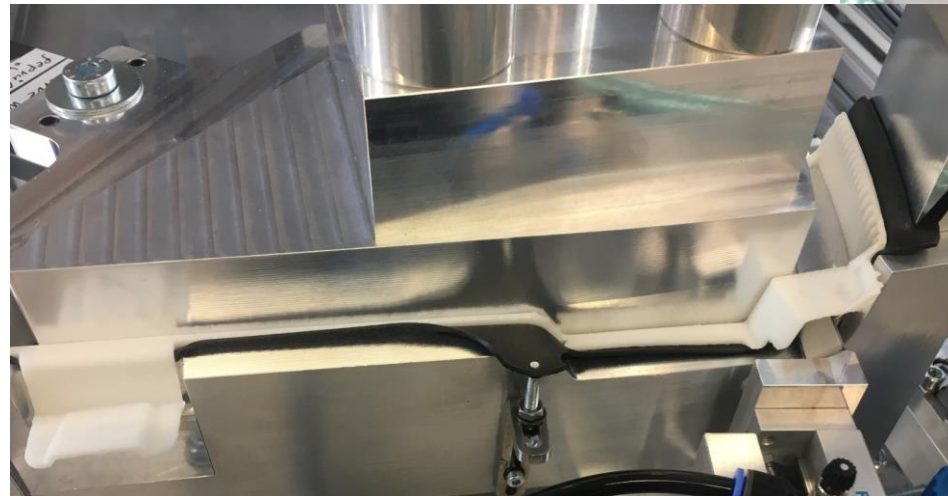
Druckteil mit Folie wird verpresst und verklebt
