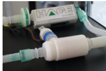
Ein 3D gefertigtes Ventil steuert die Druckzufuhr des Sauerstoffs.
